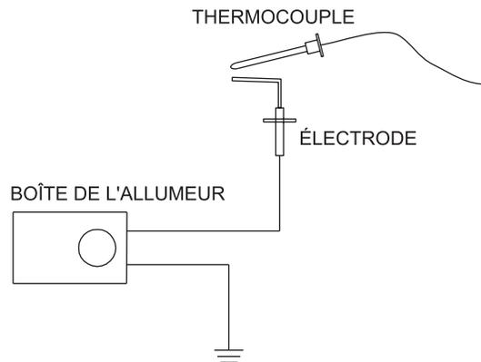
Figure 37 – Câblage du système allumeur électronique
