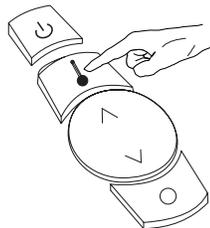
2. Lorsque la commande à distance est activée, le panneau d'affichage du foyer s'illuminera et affichera Niveau Flamme 1 ainsi que le symbole du signal à distance. Le foyer commencera la séquence de démarrage automatiquement.
